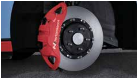
N 퍼포먼스 브레이크 시스템 (모노블록 4피스톤 캘리퍼, 불팅타입 하이브리드 디스크)
